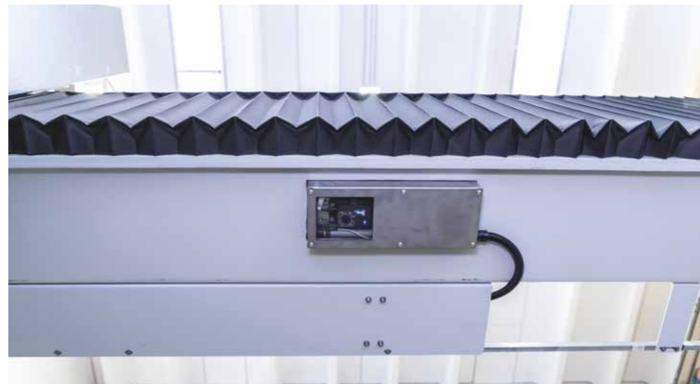
FOTOCAMERA: sistema per l'acquisizione di immagini del banco di lavoro, che consente di velocizzare il posizionamento dei pezzi di pietra nonché rilevare eventuali difetti della lastra
