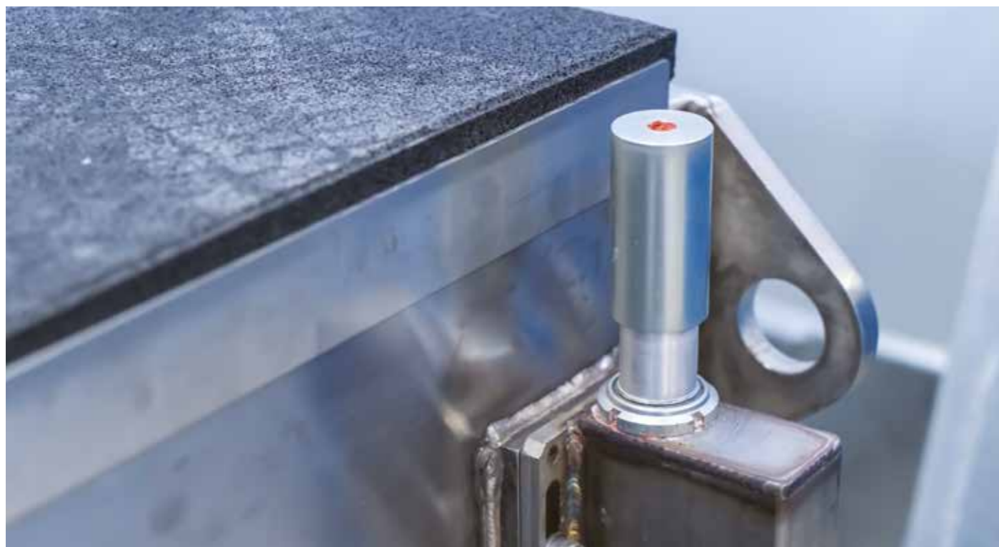
PRESETTING DISCO per misurare il diametro del disco e la lunghezza delle frese / foretti
