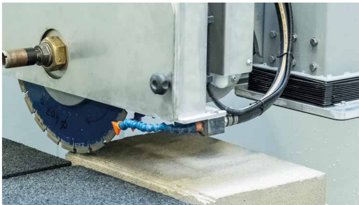
STAZIONE DI RAVVIVATURA AUTOMATICA del disco, attivabile mediante apposita funzione presente sul pannello operatore
