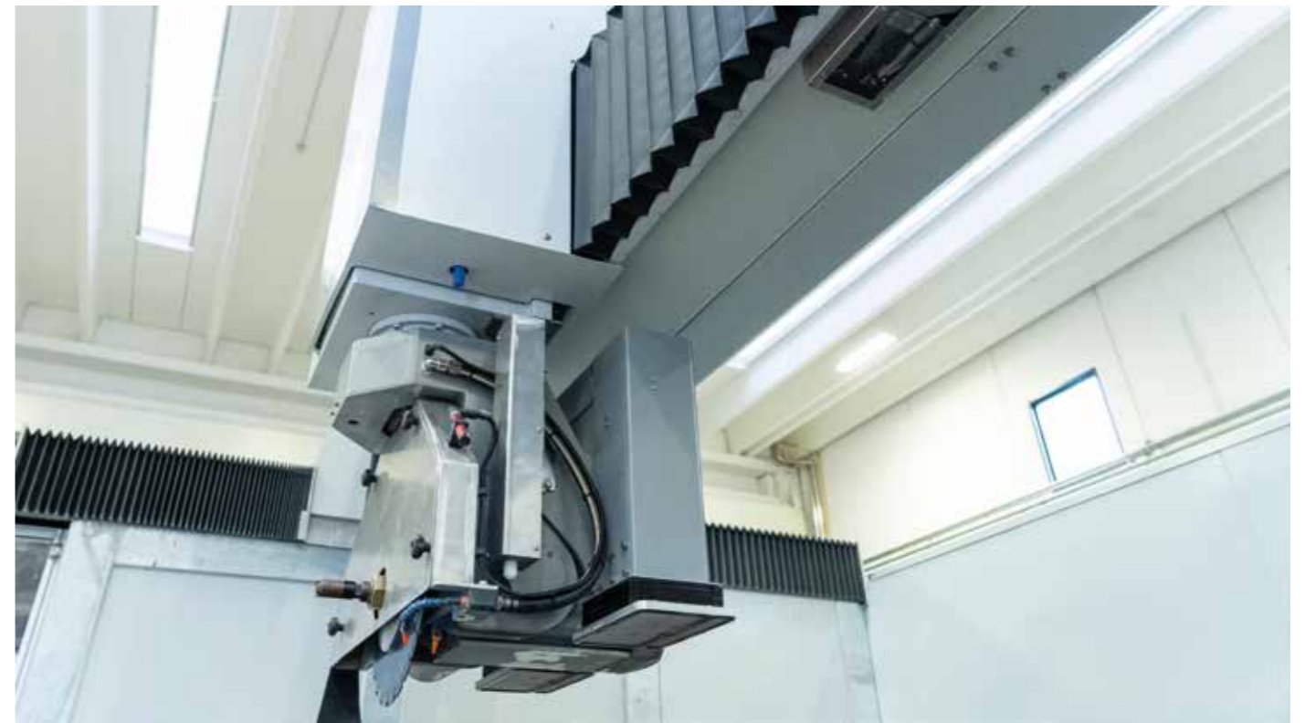
CÁMARA: sistema de obtención de imágenes del banco de trabajo que permite agilizar la colocación de las piezas de piedra y detectar posibles defectos en la losa
