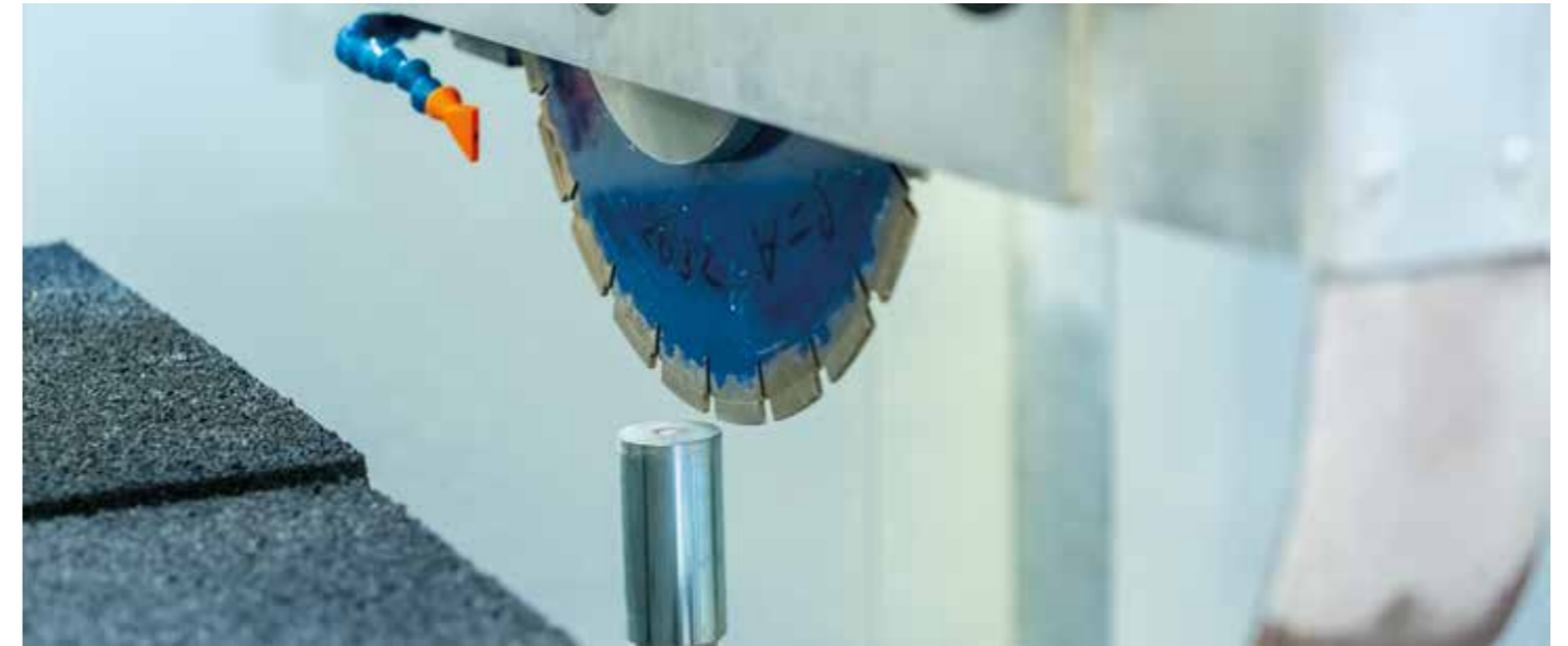
SISTEMA DE PREAJUSTE DE DISCO para medir el diámetro del disco y la longitud de las fresas/sierras
