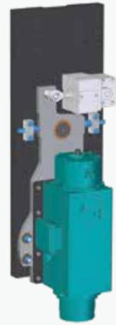
Cabezal giratorio de tres pasos para mecanizar escurridores inclinados de encimeras de cocina. Inclinando la unidad de trabajo, es posible realizar la extracción de la encimera inclinada en ambas direcciones (derecha e izquierda).
